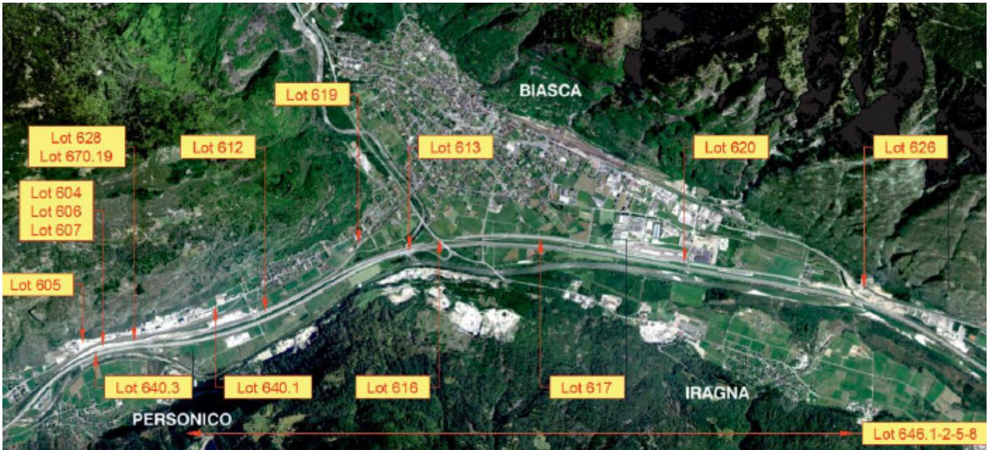
Der Abschnitt Biasca mit einer Gesamtlänge von rund 7,4 km erstreckt sich vom Südportal des Gotthard-Basistunnels bis zur Stammlinie mit dem neuen Knotenanschluss Giustizia und ermöglicht die Weiterführung in Richtung Süden im Rivieratal. Die Strecke ruht auf einer aufgeschütteten Böschung mit Ausbruchmaterial des Basistunnels, welches in den Abfallanlagen in Pollegio aufgearbeitet wurde.
